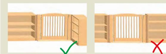
63 cm lange Regale müssen in einem Winkel von 45 oder 90 Grad zur Schwelle mit dem Törchen verbunden werden. \*
