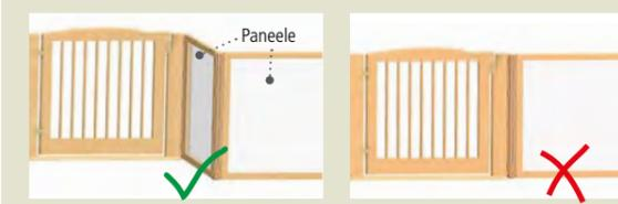
Paneele müssen in einem Winkel von 45 oder 90 Grad zur Schwelle mit dem Törchen verbunden werden. \*
